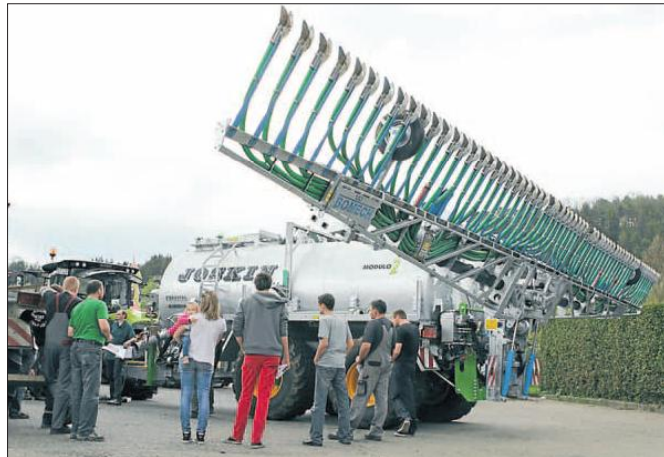
Der riesige Schleppschuhverteiler wird auf dem Feld abgesetzt, seine Düsen dringen sogar in die lockeren Ackerböden ein. So lässt sich die Gülle bodennah ausbringen, die Nährstoffe kommen konzentriert dort an, wo sie gebraucht werden: In der Erde und bei den Pflanzen. Auch die CO 2 -Emissionen werden dadurch deutlich reduziert. FOTO: SCHRADE
